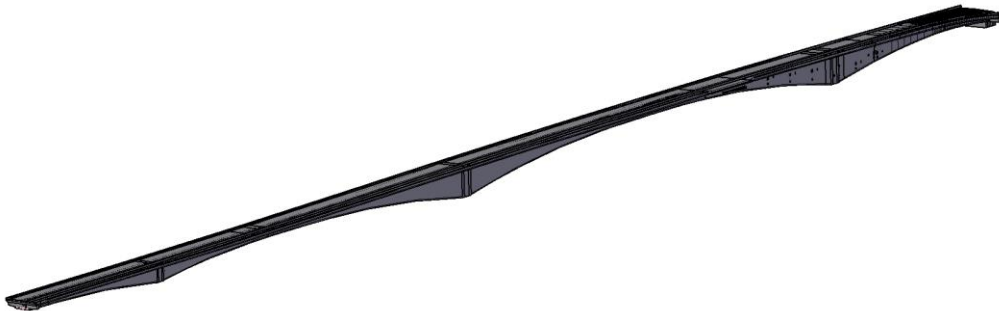
3D modell fra Autocad som viser Varrodbuas overbygning.
