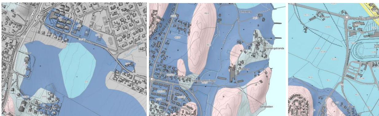
Figur 6-2 viser utsnitt fra NGUS kartdatabase over løsmasser i Kolberg (t.v.), Smørberg og Jarlsberg (t.h.). Lyseblå felt tilsvarer tykk havavsetning, og mellomblå felt viser marin strandavsetning.
