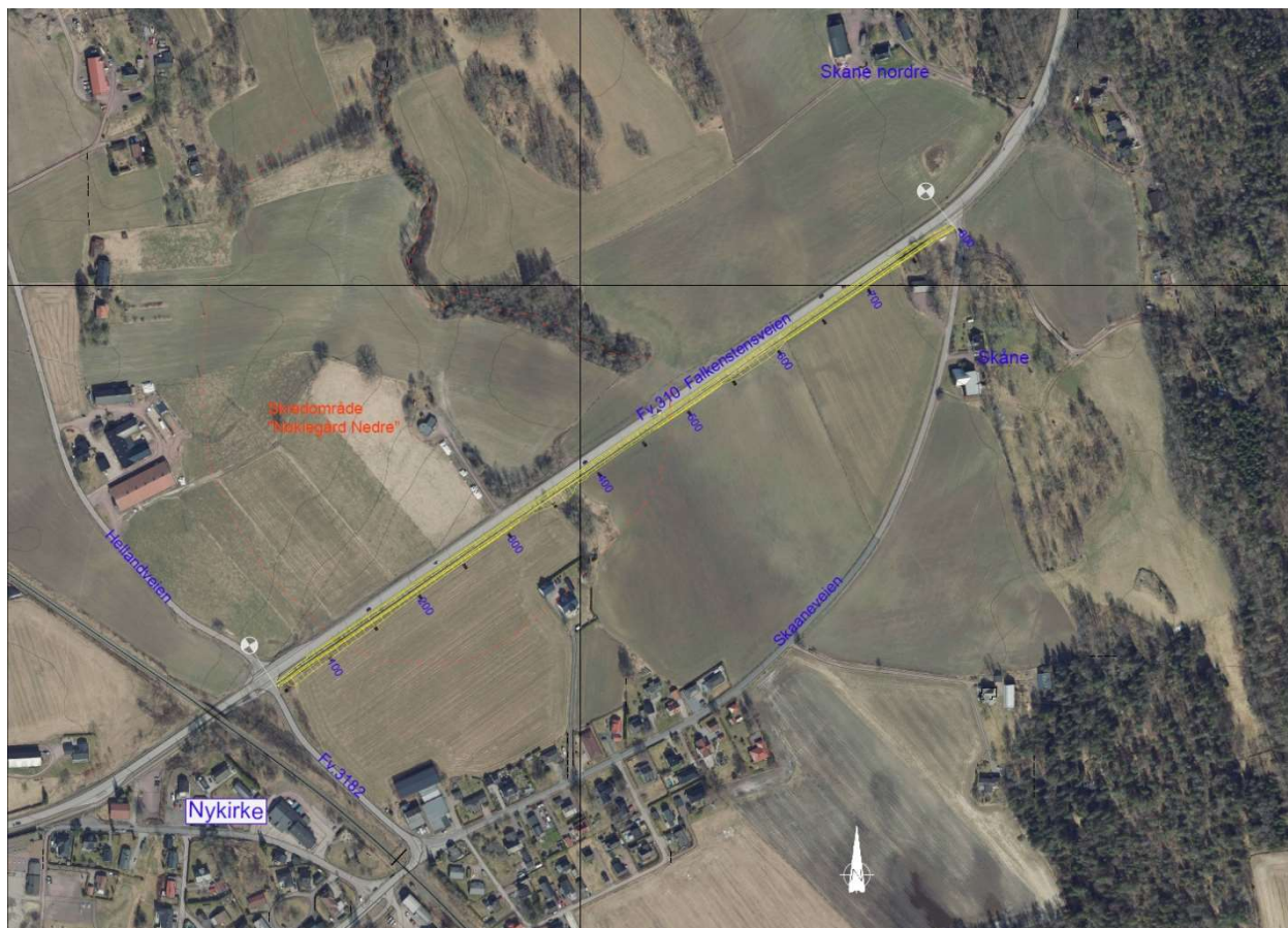
Figur 1-1. Oversiktstegning over prosjektert gang- og sykkelvei langs Fv. 310, mellom Nykirke og Skaaneveien. Tiltaksområdet er illustrert med gul farge, sør for Falkenstensveien. Illustrasjon: Fylkeskommunen i Vestfold og Telemark.
