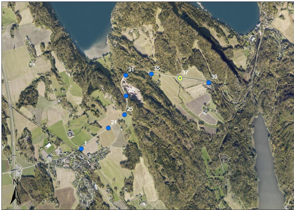
*Figur 4.1 Viser tilstandsklassen til jordprøvene i hvert punkt. Gul farge i punkt 37 representerer tilstandsklasse 3 moderat fra 0-1 meter mens blå farge representerer tilstandsklasse 1 svært god fra 1-2 meter. Øvrige punkt med blå farge representerer tilstandsklasse 1 meget god.*
