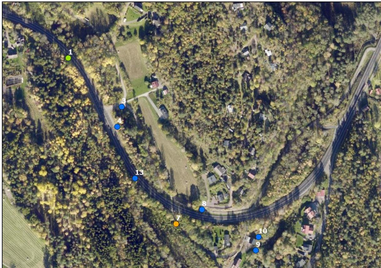
Figur 4.3. Viser tilstandsklassen til jordprøvene i hvert punkt. Grønn farge i punkt 1 representerer tilstandsklasse 2 god, orange farge i punkt 7 representerer tilstandsklasse 4 dårlig. Øvrige punkt med blå farge representerer tilstandsklasse 1 meget god.
