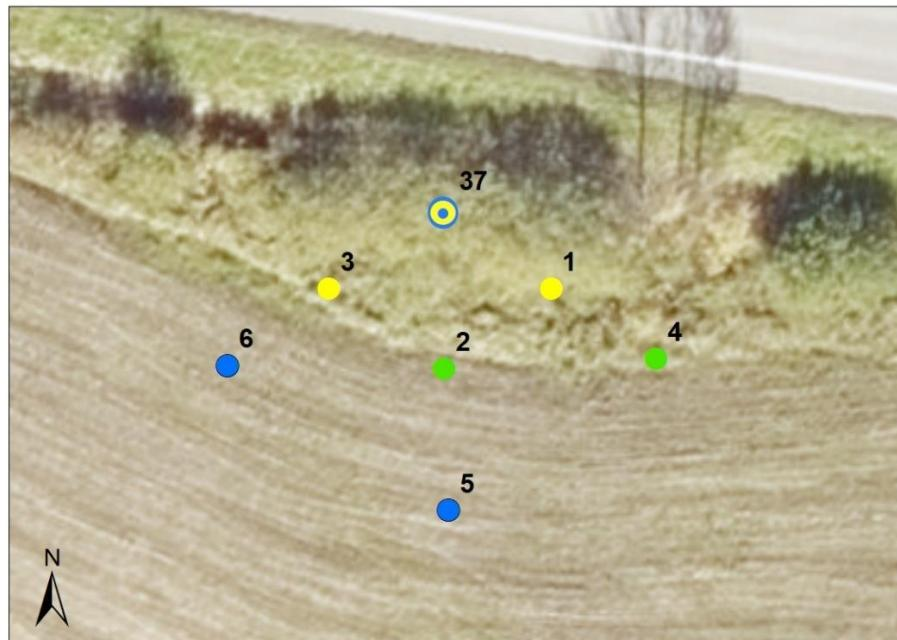
*Figur 4.2 Viser tilstandsklassen til jordprøvene i hvert punkt. Gul farge i punkt 37 representerer tilstandsklasse 3 moderat fra 0-1 meter mens blå farge representerer tilstandsklasse 1 meget god fra 1-2 meter. Gul farge i punkt 1 og 3 representerer tilstandsklasse 3 moderat, mens grønne farge i punkt 2 og 4 representerer tilstandsklasse 2 god. Øvrige punkt med blå farge representerer tilstandsklasse 1 meget god*
