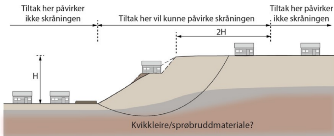
Figur 3 Utsnitt fra figur 3.4 i NVE 1/2019 som viser prinsipp for når en skråning kan vurderes som upåvirket av tiltaket.
