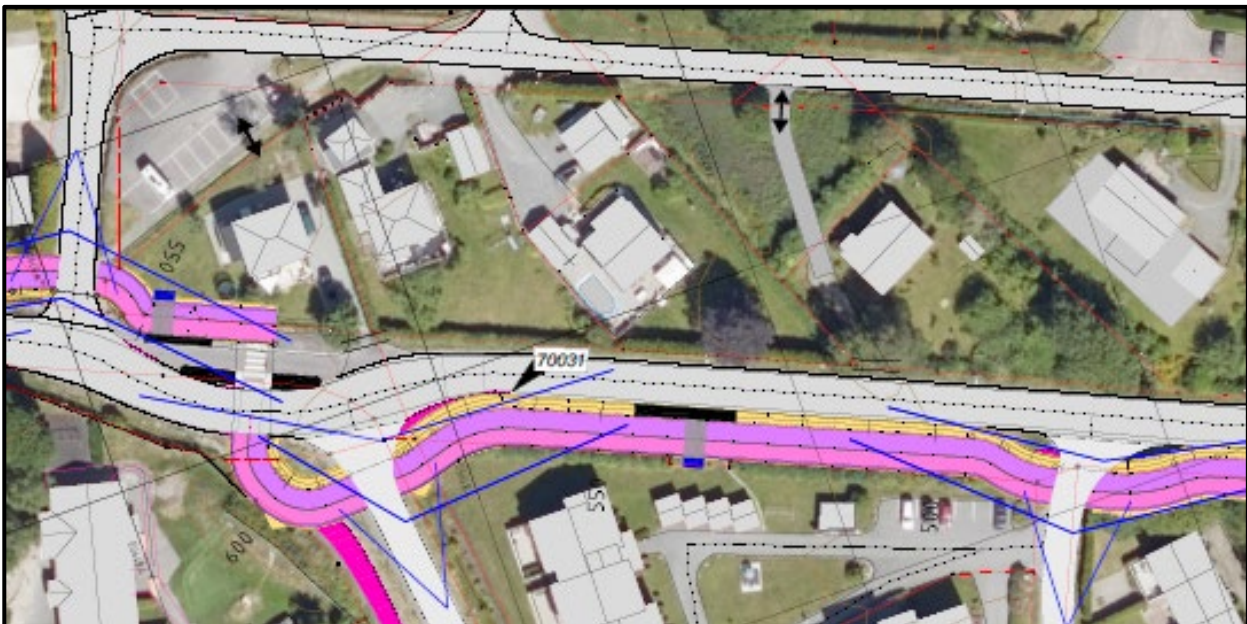
Figur 22 – Avkjørselssaneringer ved Krokemoveien 75 og 81 og nye avkjørslar til Maratonveien.
